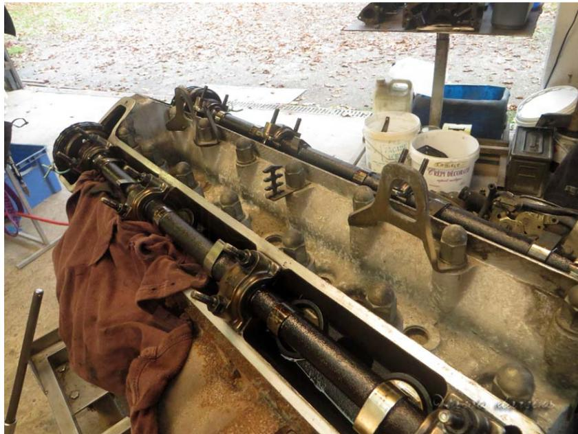
De ce coté les nouvelles sont bonnes, les arbres à cames sont parfaits et les jeux tout à fait corrects. Pour 0,30, je note deux soupapes d'échappement à 0,40, deux d'échappement et une d'admission à 0,35 et le restant à 0,30. Voici un tableau des mesures relevées :
